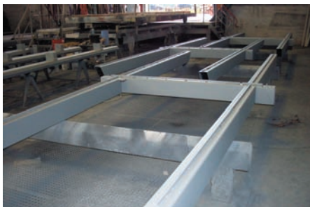
Vorgefertigte Leiterelemente aus Hohlprofilen
