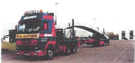
Bild 6. Spezialtransportfahrzeug mit Halbbinder (© Spedition Hoffmann)
