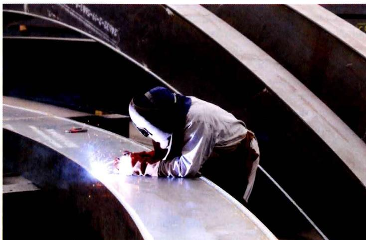
Fertigung am Kastenträger, die Verbindungen der Einzelemente wurden als geschraubte Konstruktion konzipiert
