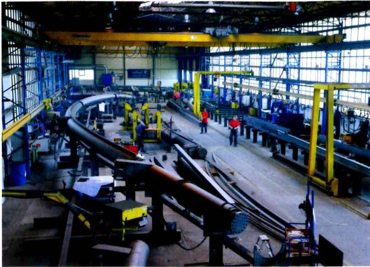
Die Längswandbinder und die freitragenden Giebelbögen wurden wegen der komplizierten Geometrie in einer 1:1 Schablone gefertigt
