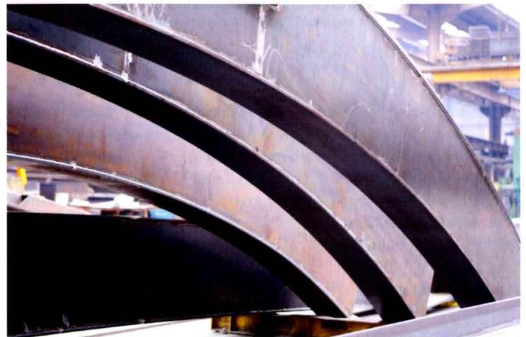
Die Kastenträger sind aus Blechen unterschiedlicher Dicke zusammengesetzte Hohlkästen,  $b/d = 300 \times 700$  mm
